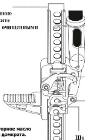
Рисунок 9. Места смазки домкрата.
