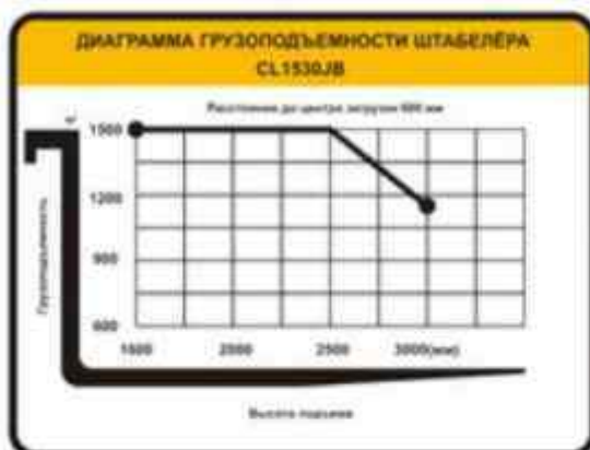
Рисунок 4. Диаграмма грузоподъемности штабелера.
