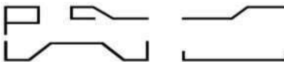
Рис. 2 - Формы изгиба арматуры
