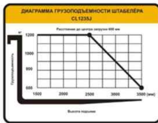
Рисунок. 4. Диаграмма грузоподъемности штабелера.
