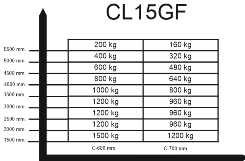
Рис. 3 – Кривая грузоподъемности штабелера CL-GF
