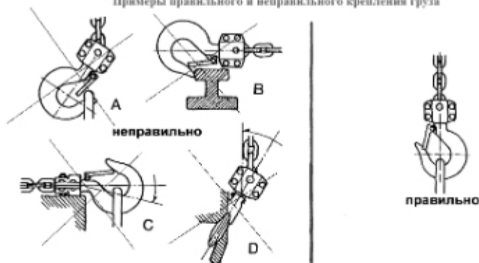
Примеры правильного и неправильного крепления груза
