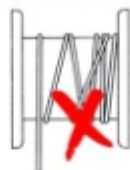
Рисунок 3. Намотка троса на катушку.
