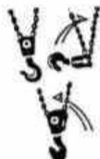
Рис. 5 Неправильное положение крюка
